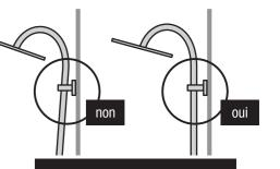
\* Vérification aplomb/mur réglage en profondeur des pieds
